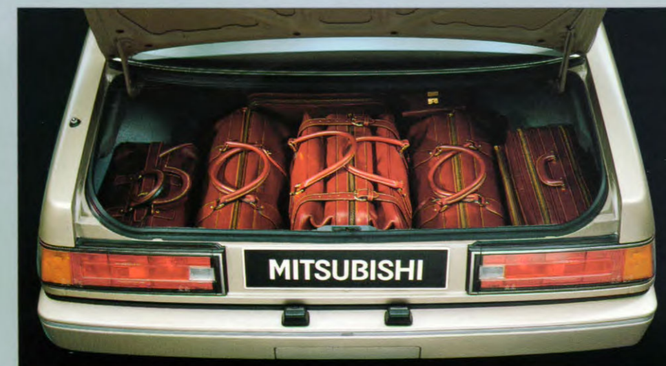
Er kan ongekend veel bagage mee, dankzij de ruimtewinst door voorwielaandrijving én door de plaatsing van de benzinetank vóór de achteras. Hierdoor beschikt u over een bagageruimte van 600 liter.
