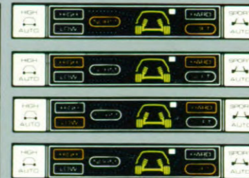
De instelmogelijkheden van de ECS op het dashboard van de Galant GLS/E.
