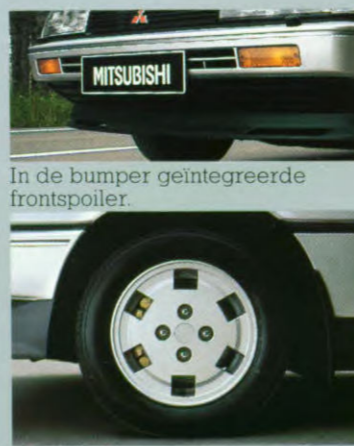
Lichtmetalen velgen met 195/60HR14 banden behoren tot de standaarduitrusting.
